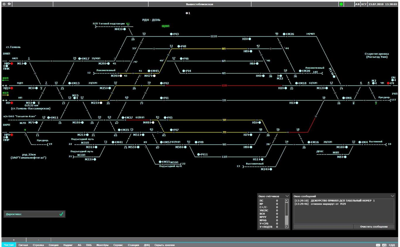
Рисунок 4 – Пример вида главного рабочего окна с открытым окном счетчиков и окном сообщений на мониторе ПЭВМ АРМ ДСП
