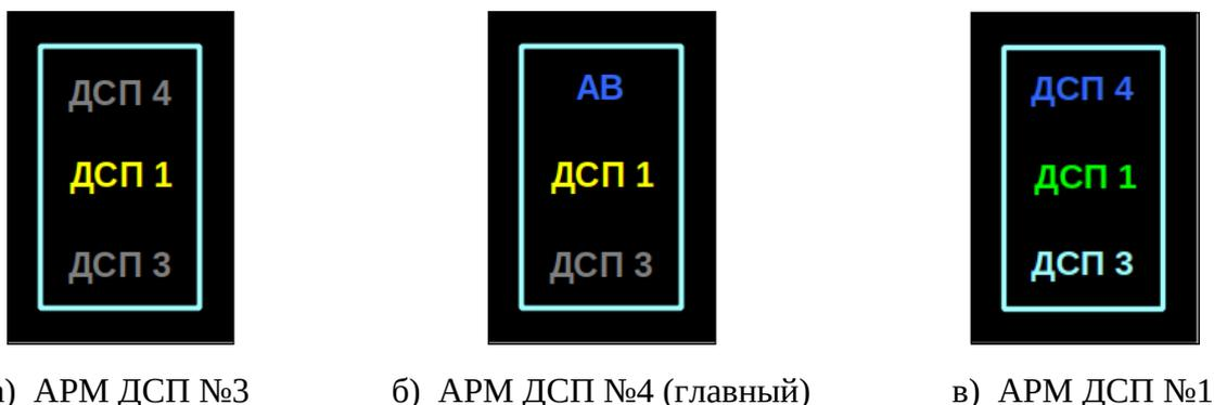
Рисунок 188 – Примеры отображения статусного индикатора зоны, управление которой может быть доступно одному из трех ДСП (№4 (главный), №1, №3), после завершения переключения управления:
